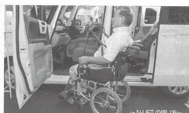
(1)車椅子に吊り紐付きのクッションを敷いており、車内に設置したリフトに引っ掛ける。
