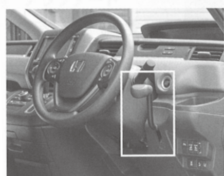
手動ブレーキによって、踏み間違いを起こしても、「手で」素早くブレーキを掛けられる。
