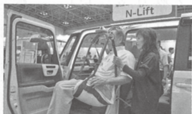
(2)介助者がスイッチを使って持ち上げ、リフトを使って助手席に送る。
